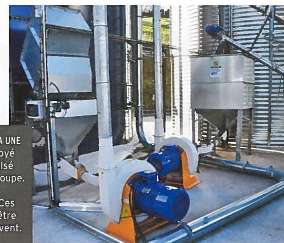
◀ LE REMPLISSAGE DES SILOS est effectué avec une suceuse entraînée par la prise de force du tracteur. Un système moins coûteux qu'un élévateur.
