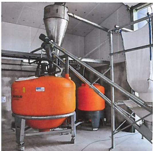
▲ LA MACHINE À SOUPE sert de mélangeuse. Les céréales, les matières premières protéiques et les minéraux arrivent directement sans mélange préalable.
