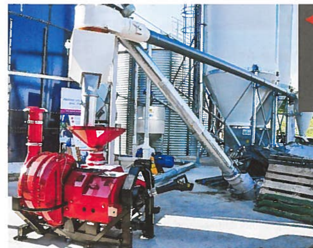
▶ LE MAÏS EST REPRIS VIA UNE TRÉMIE pour être broyé (1er plan) puis expulsé vers la machine à soupe. En arrière plan, le broyeur à céréale. Ces équipements vont être protégés par un auvent.
